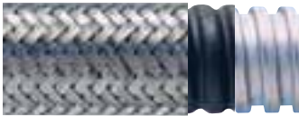
Serie SPTC Guaina in acciaio zincato con rivestimento in PVC Trecciatura in rame stagnato, Alta Schermatura EMI
